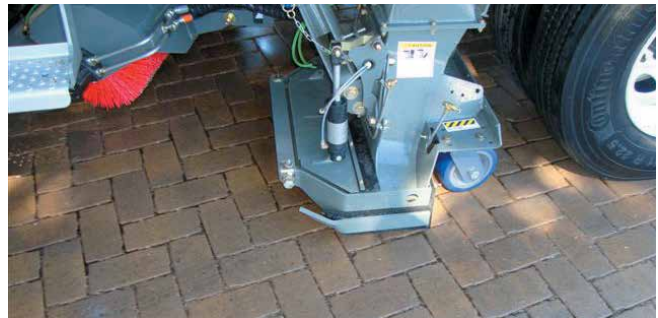
Camión aspirador para mantenimiento de restauración.
