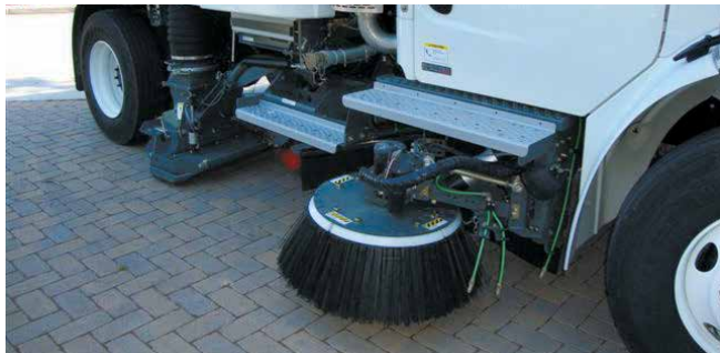
Barredora de aire regenerativo para mantenimiento regular.
